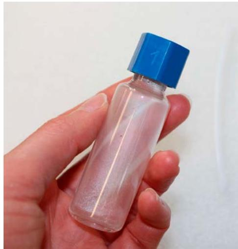
**Abb. 3** Gasdicht verschlossenes 20-ml-Schraubglas mit einer Ausatemluftprobe
