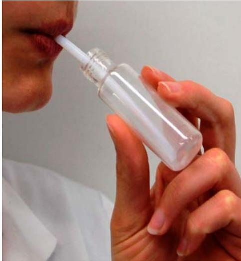
**Abb. 2** Gewinnung einer Ausatemluftprobe mittels PTFE-Rohr und 20-ml-Schraubglas
