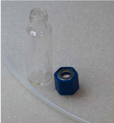
**Abb. 1** Material zur Gewinnung einer Ausatemluftprobe: 20-ml-Schraubglas, Lochschraubkappe mit eingelegtem PTFE-beschichtetem Septum, PTFE-Rohr
