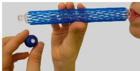
**Abb. 4** Gewinnung einer Ausatemluftprobe mittels Gassammelrohr Typ BAuA, (Quelle: [21]; <https://doi.org/10.1155/2014/904512>)
